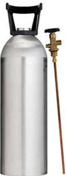
**Cilindro:** El cilindro debe estar equipado con un Vástago, sifón o "tubo de inmersión"; de lo contrario, difícilmente se genera nieve carbónica.
